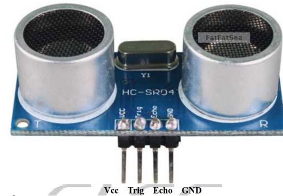
Beispiel: HC-SR04 Messbereich 2-300cm Genauigkeit ca. 3mm
